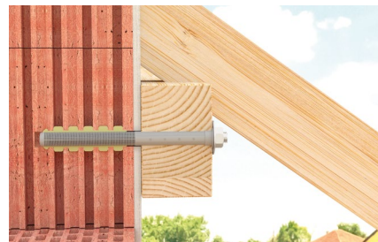
Detail: Kotvení tesařských prvků průvlečnou montáží
