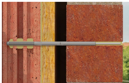
Detail: prokotvení nosné a vnější vrstvy
